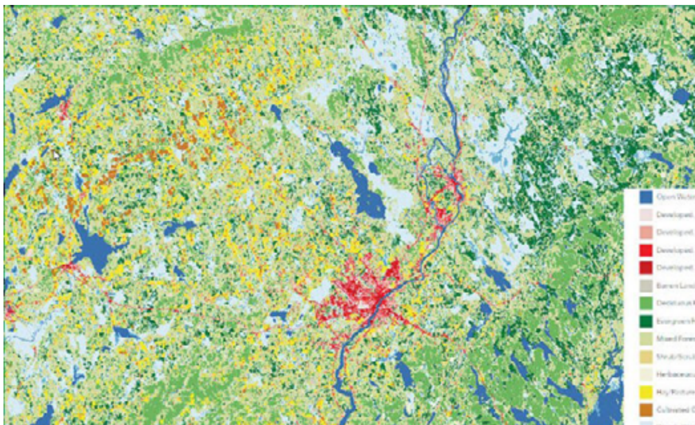
Модель Land Cover Classification (Landsat 8) можна використовувати для аналізу змін із низькою роздільною здатністю у часовому ряді.
