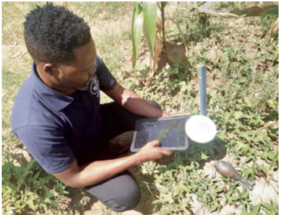
Керівник з розмінування в Анголі фіксує місцезнаходження нерозірваних боєприпасів за допомогою Trimble DA2 і ArcGIS Survey123. (Фото надано The HALO Trust)
