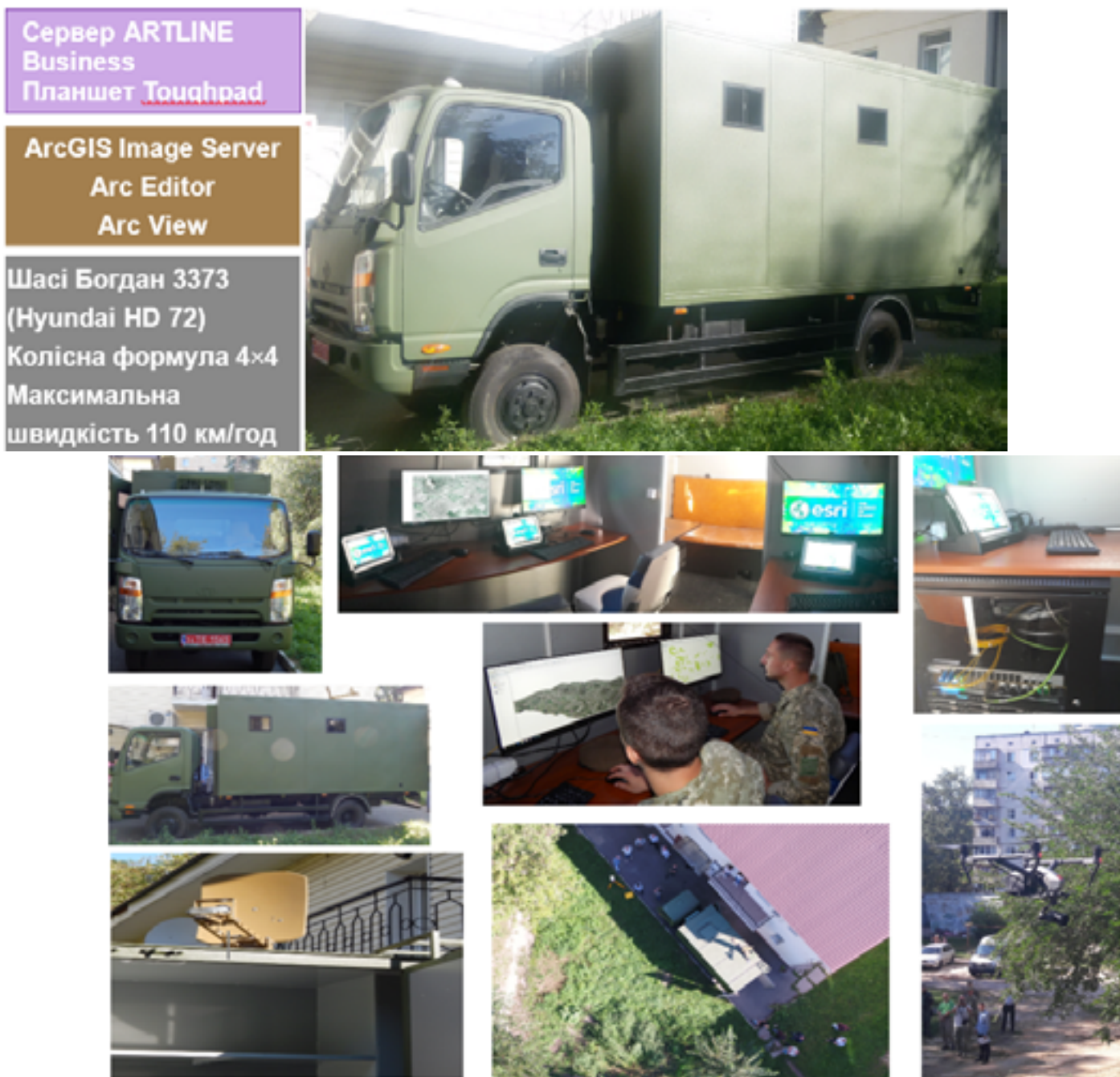
Рис. 3. Рухомий програмно-технічний комплекс управління геопросторовими даними (А-загальний вигляд, Б-внутрішня частина)
